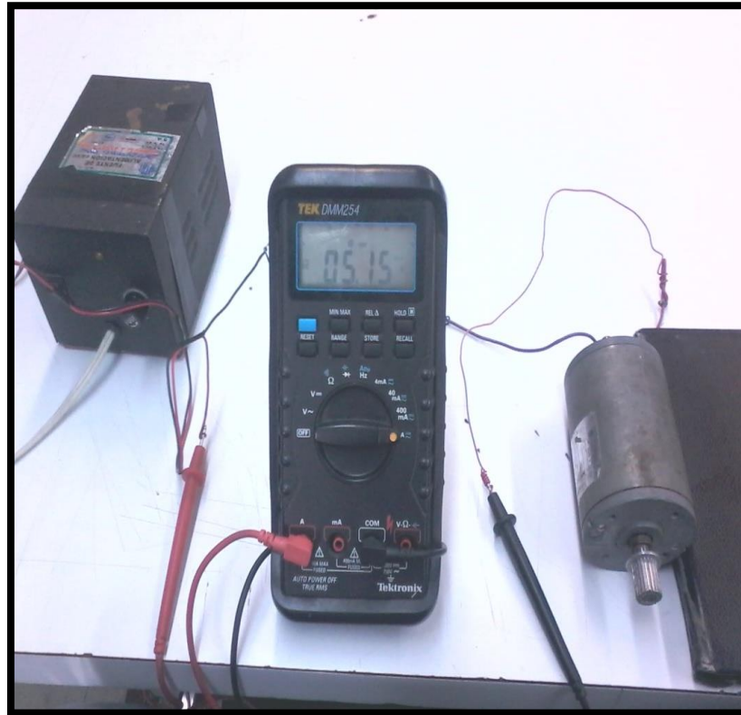
Figura 8. Medición de la corriente de arranque del motor de CD.
