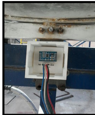
Figura 19. Construcción del chasis del sensor
